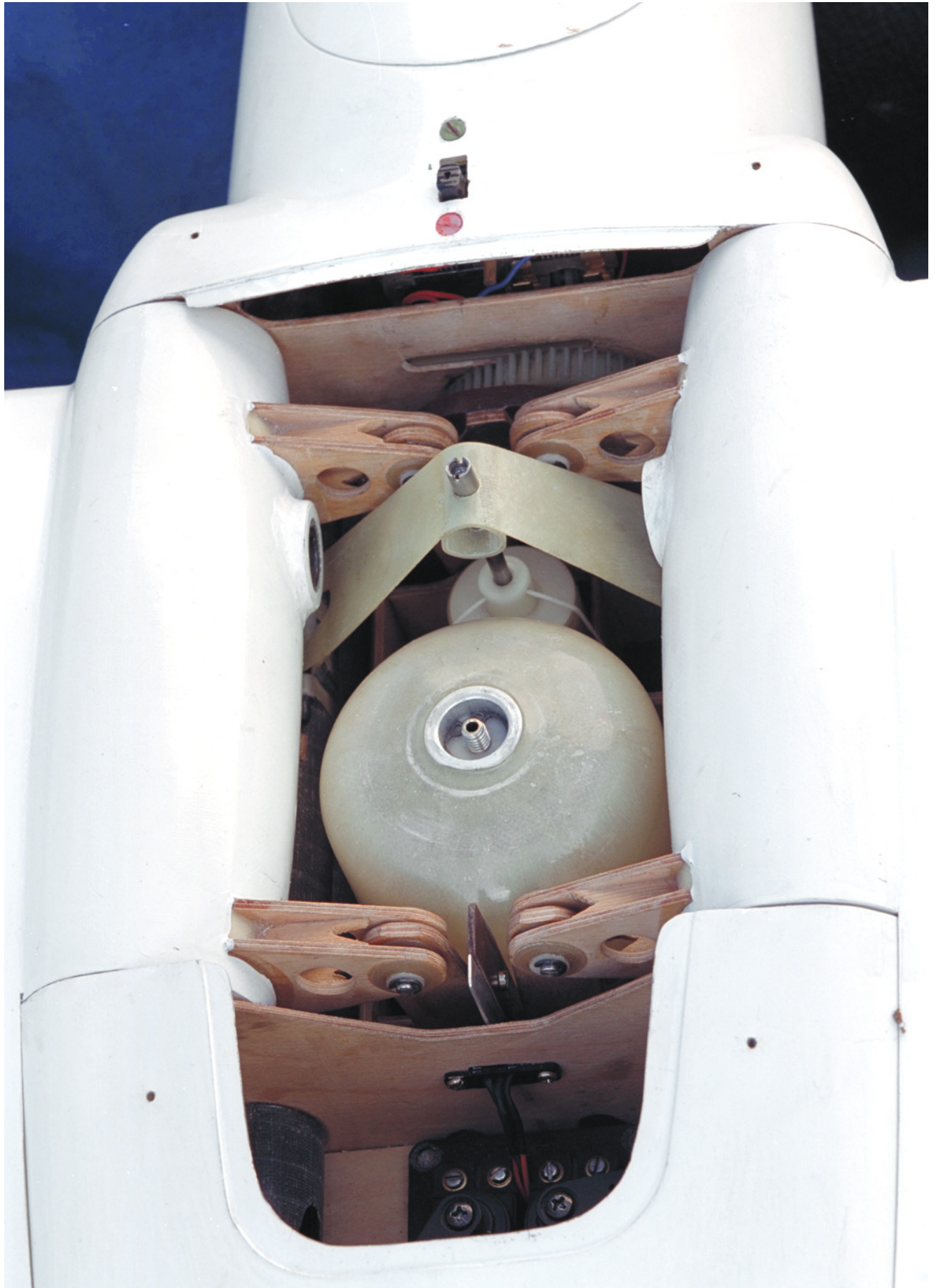
Foto 13 Aandrijfmechanisme met een gasdruk- en eindpositieveer
