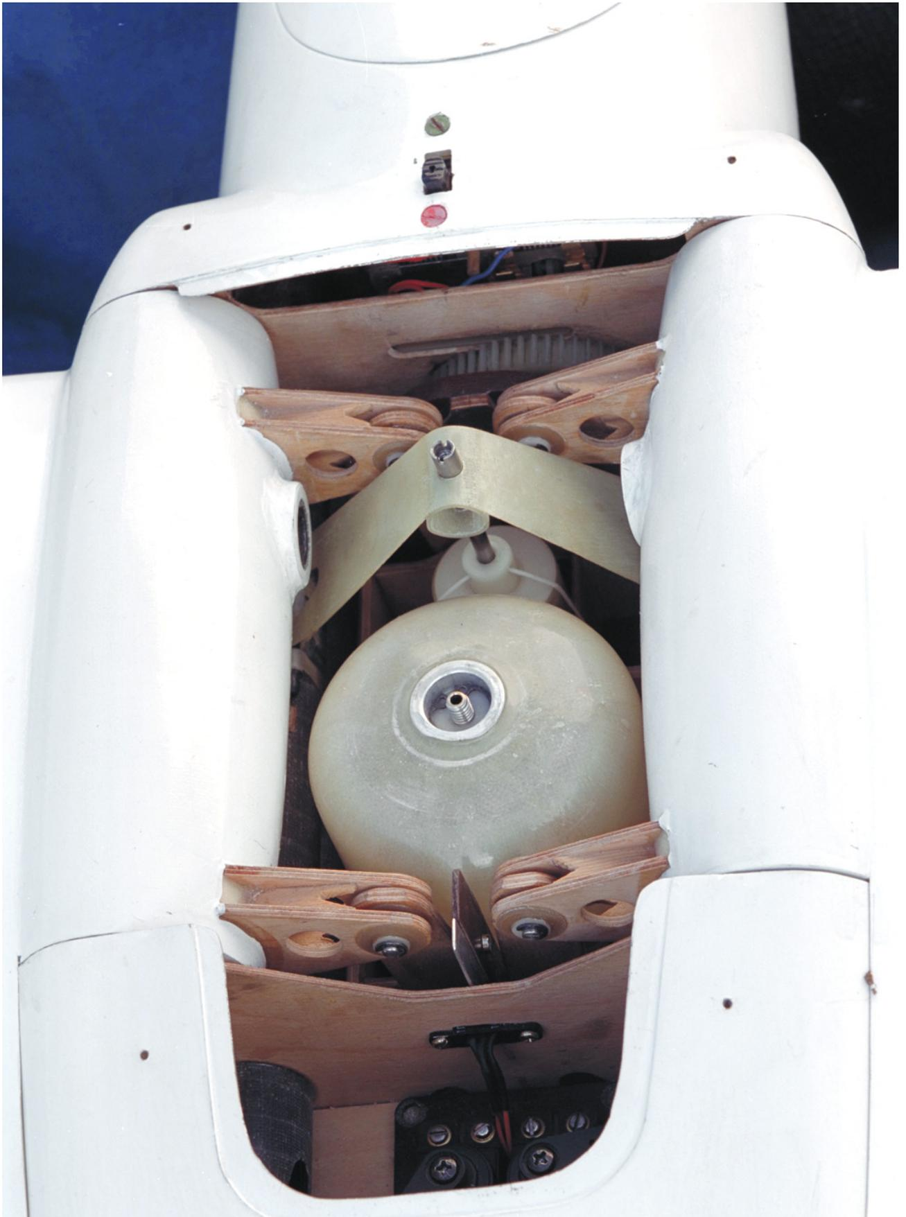
Photo 13 dispositif d'aile battante avec ressort de compensation pneumatique et ressort de fin de course
