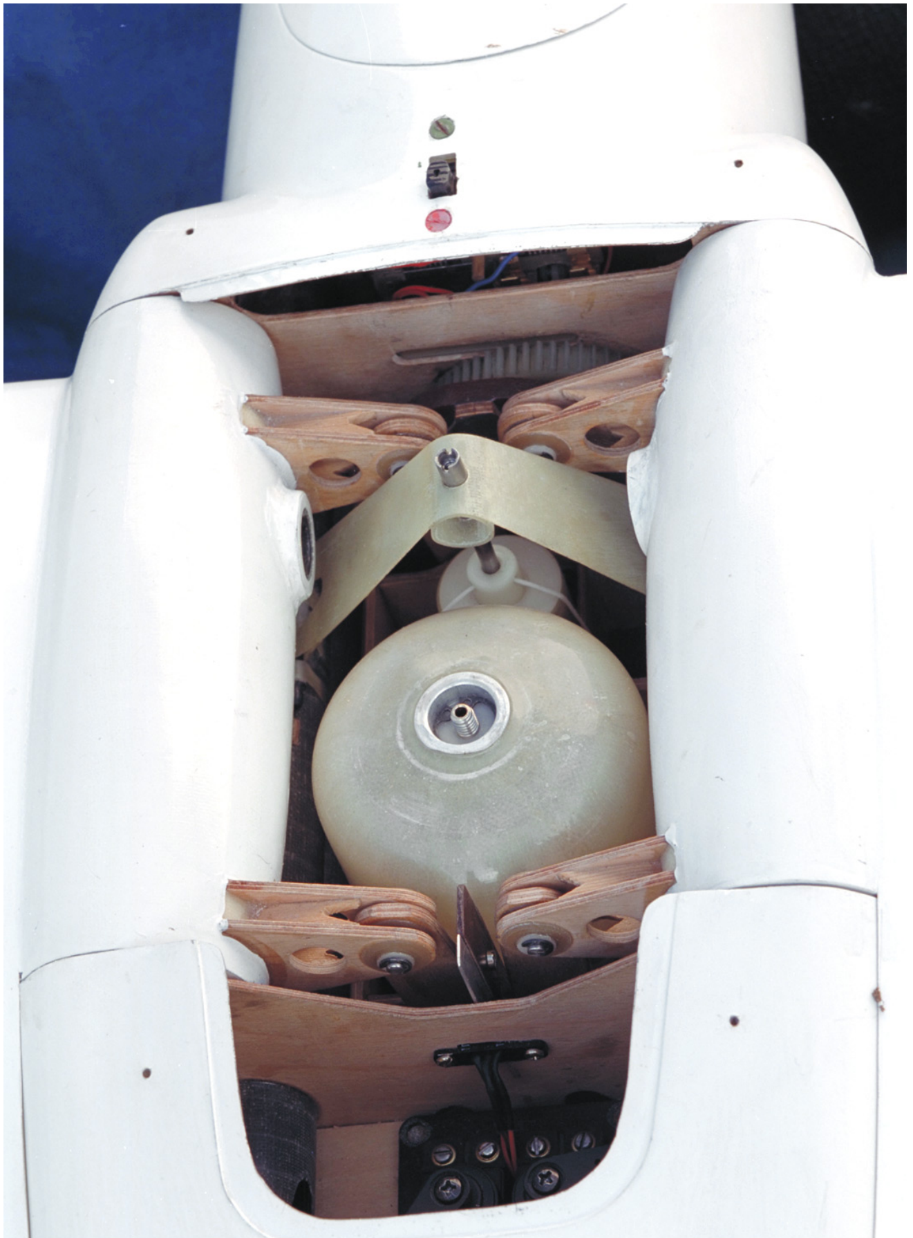
Foto 13 Schlagflügelantrieb mit Kompensations- und Endlagenfeder
