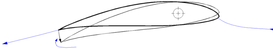
Bild 18 Mögliche Tendenz zur Umströmung der Profil-Hinterkante bei schneller Vergrößerung des Anstellwinkels um eine weit vorne liegende Drehachse.
